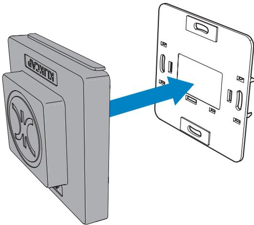
Veillez pour chaque **KlikCap/KlikCap** avec poignée à ce que les ergots de positionnement soient insérés dans les trous correspondants.
