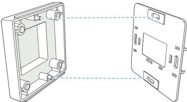
Installez le **KlikCap** de manière à ce que la bordure en plastique sur le **KlikCap** vienne au-dessus du cadre en fer. Elle évite la pénétration des matériaux dans la prise ou l'interrupteur mural.
